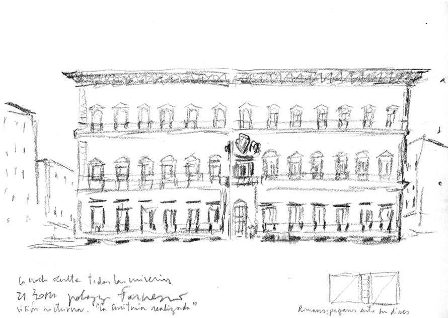
Palacio Farnesio, Roma. Esta es una visión nocturna. La noche tiene de particular que oculta todas las miserias. Claramente se percibe el trazado que regula la fachada. En el Renacimiento se plantearon una serie de sistemas de proporcionalidad para controlar la composición. Y el número se hizo carne. La eunitmia realizada.
